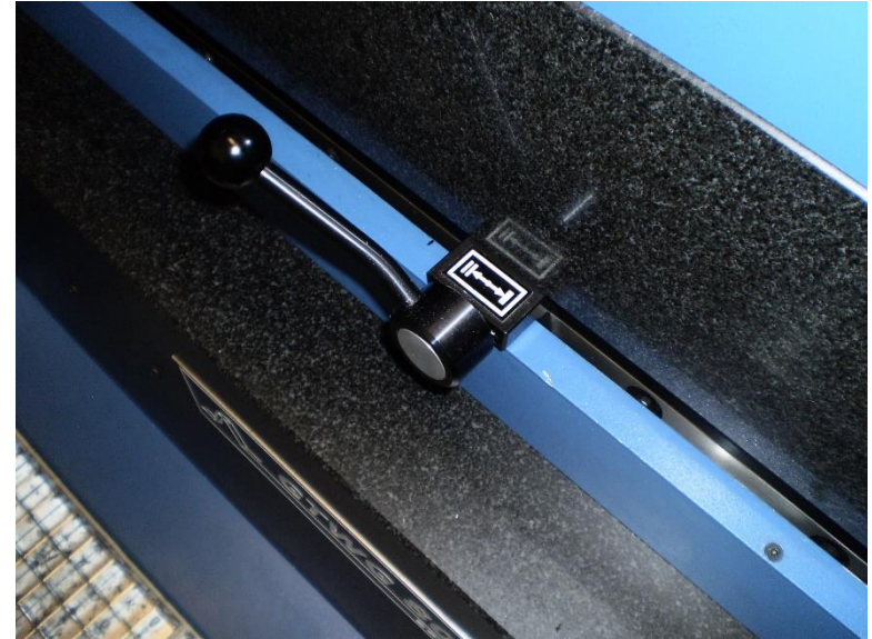
Wahl zwischen Zwei- und Einflankenmessung
